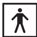
Protección de tipo BF (grado de protección frente a descargas eléctricas; no existe ninguna conexión conductiva al paciente)
